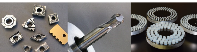
Abbildung 2 und 3: Kantenverrunden und Polieren von Wendschneidplatten und Schneidwerkzeuge aus Hartmetall
